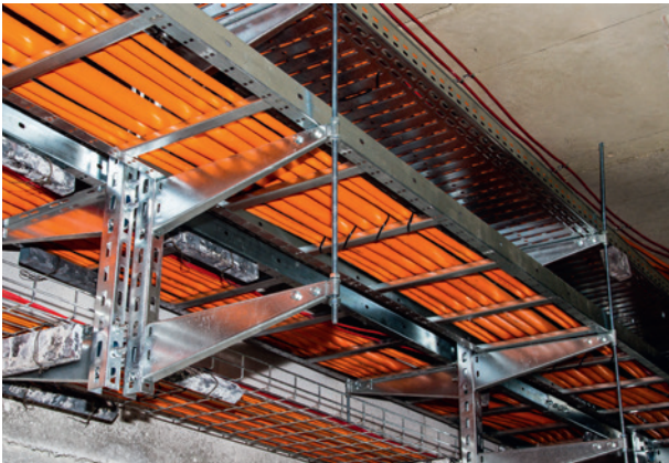
Zespół tras kablowych po badaniu E90 wg DIN 4102-12
